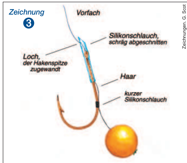
Line Aligner: Durch ein schräg abgeschnittenes Schlauchstück dreht sich der Haken bei Zug besser ins Fischmaul rein.
